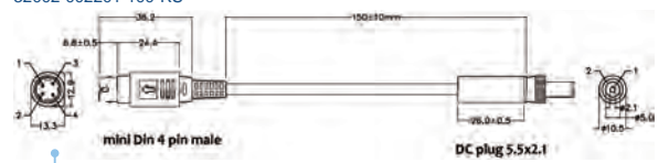
DC Power Cable (DC plug to mini DIN) 32002-002201-100-RS
